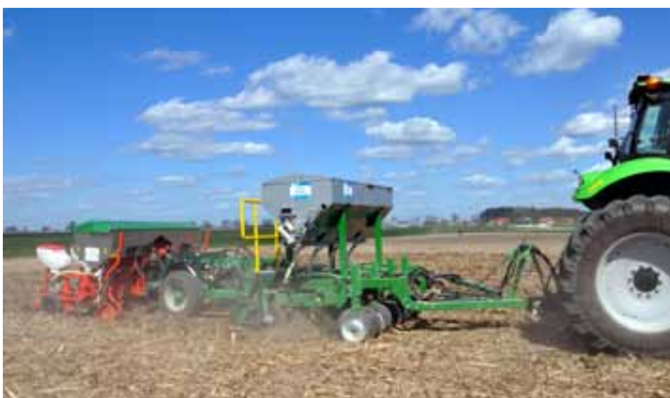
Zdj. 1 Model badawczy agregatu do jednoczesnej uprawy pasowej, nawożenia i siewu kukurydzy (wynik projektu PBS1/B8/4/2012)
