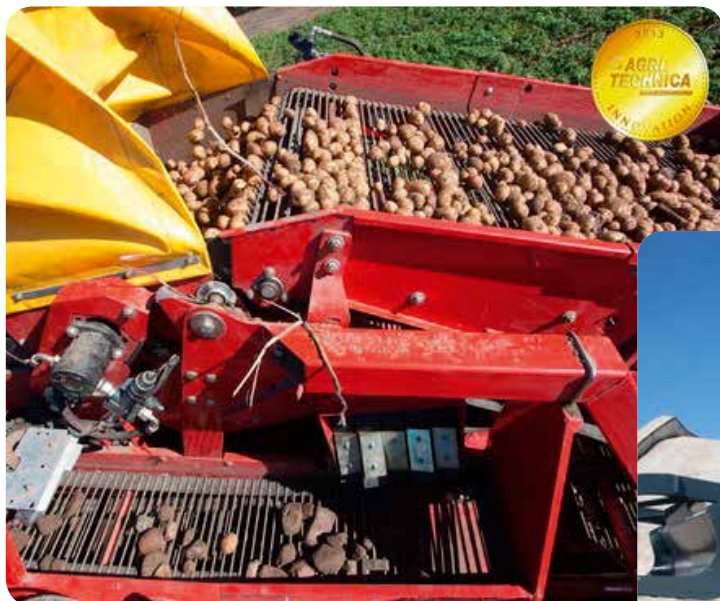
1. Pneumatyczne urządzenie do oddzielania zanieczyszczeń Air-Sep Grimme Landmaschinenfabrik GmbH & Co. KG, Damme.
