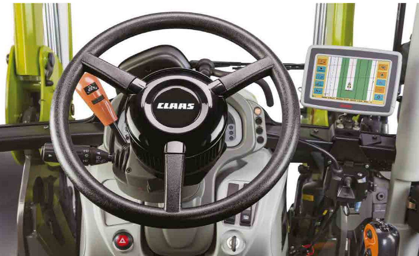
System CLAAS GPS PILOT FLEX S7. Kierownica elektryczna i terminal S7.
