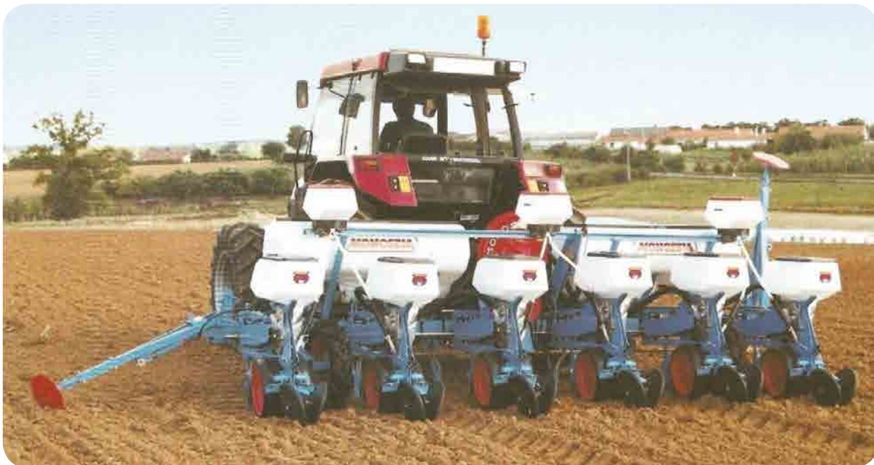
Rys.1 Siewnik Monosem przystosowany do wysiewu mikro-granulatu
