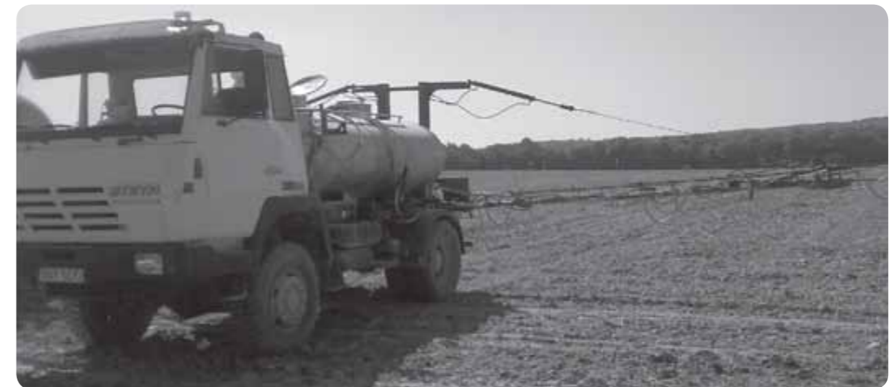
Rys. 2. Samojezdny aplikator nawozów zawieszinowych.
