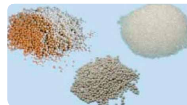
Typ cząsteczki zależy od procesu produkcji: granulowana saletra amonowa, nawóz trójskładnikowy NPK drobnogranulowany (prilled) i krystaliczna saletra wapniowa (norweska) wymagają różnych ustawień rozsiewacza nawozu.
