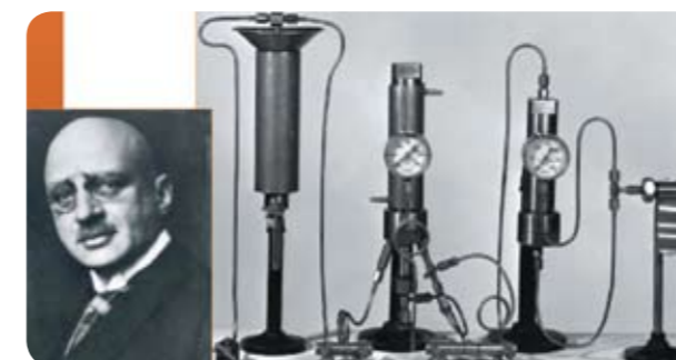
Fritz Haber. Instalacja laboratoryjna użyta przez Habera do syntezy amoniaku w 1908 r.
